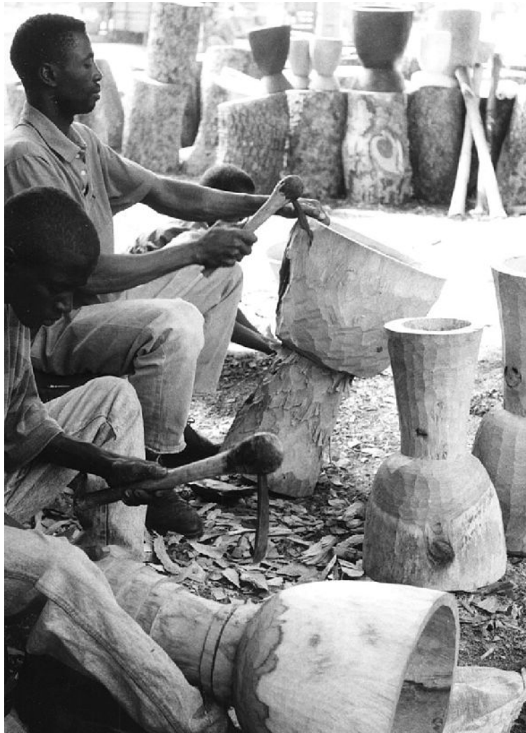
Abb. 1: Herstellung von Jenbe-Resonanzkörpern durch spezialisierte Holzhandwerker in Bamako. Der Schnitzer Isu Kumare und seine Gehilfen produzieren arbeitsteilig und überwiegend für den Export. (Photo: Polak 1998)
